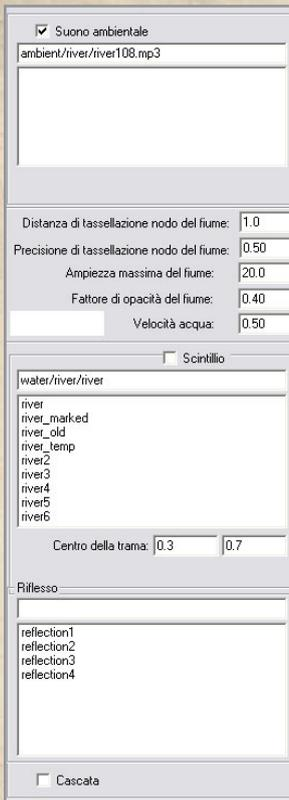
Il pannello laterale dell'Editor di fiumi ci consente di regolare certi parametri dei corsi d'acqua: potremo modificarne la trama (con "Distanza di tassellazione nodo del fiume" e "Precisione di tassellazione nodo del fiume"), cambiarne l'ampiezza massima, regolare il fattore di opacità (per vedere meglio o peggio il fondo) o la velocità dell'acqua.
